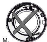
Conexiunile de 100–240 V.c.a. și 12 V.c.c. nu trebuie să fie simultanе (figura M).
