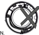
Подключение 100–240 В не может быть установлено над компонентом электроники (рис N).
