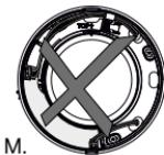
Der Anschluss von 100–240 VAC und 12 VDC darf nicht gleichzeitig erfolgen (Abbildung M)
