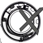
Na elektronické části spotřebiče nesmí ležet žádné kabely 100–240 V (Obrázek N).
