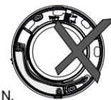
Este interzisă trecerea cablurilor de 100–240 V peste componentele electronice (figura N).
