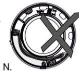
Er mogen geen 100 - 240 V-kabels over de elektronische componenten worden geleid (afbeelding N).
