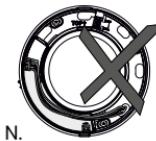
100–240-V-Kabel dürfen nicht über die Elektronikkomponente verlegt werden (Abbildung N).
