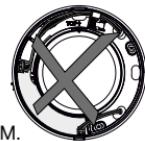
Het is niet toegelaten om tegelijk een aansluiting op 100 - 240 VAC en op 12 VDC te realiseren (afbeelding M).
