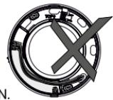
*Aucun câble 100–240 V ne doit reposer sur les composants électroniques (Figure N).*
